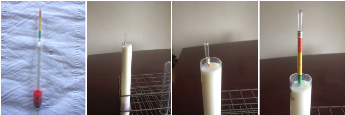
Pèse colostrum (photo de gauche) immergé dans un tube de colostrum (photo de droite)
