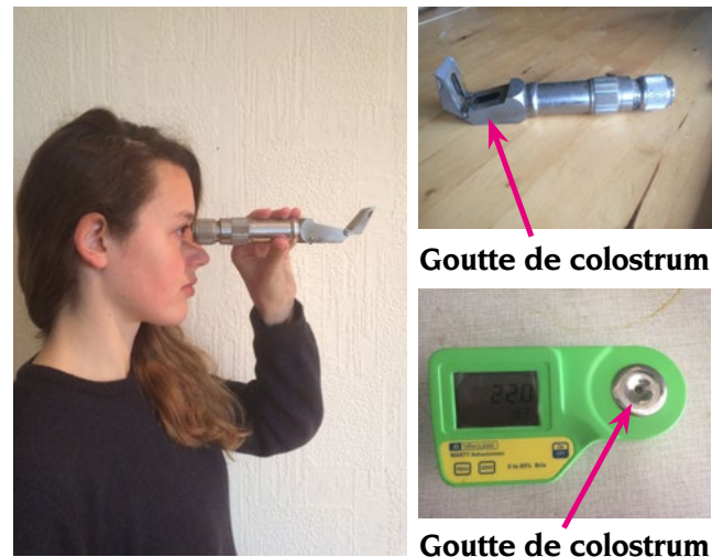
Figure 21 – Réfractomètres optique (images du haut) et digital (image du bas) utilisés pour l'évaluation de la qualité du colostrum
