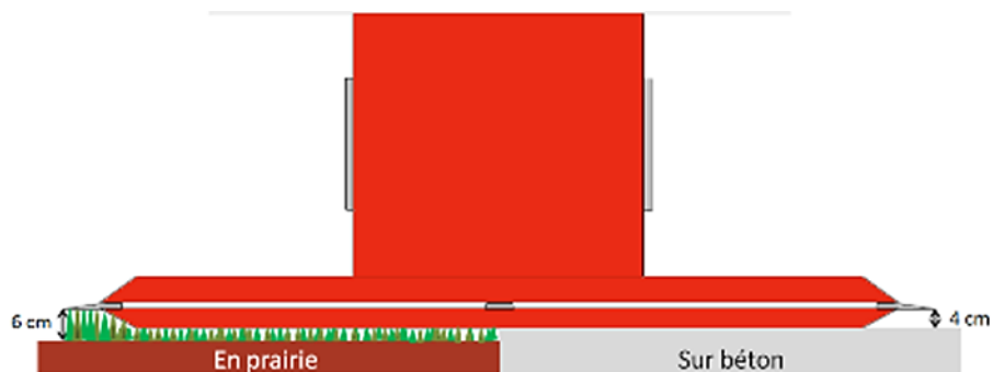
Figure 9 - Réglages de la hauteur de coupe avec une faucheuse rotative (Crémer S., 2014)
