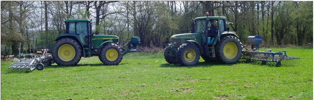
Photo 60. Différentes possibilités d'agencement d'un semoir
