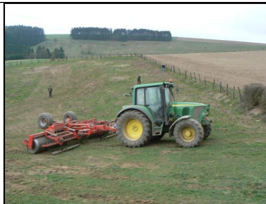
Photo 72. Herse étrille équipée d'une barre niveleuse et de gros rouleaux
