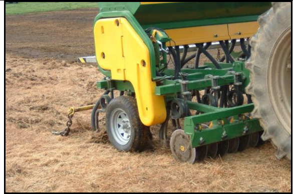
Photo 66. Les disques du semoir spécifique creusent des sillons dans le sol
