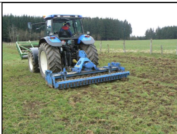
Photo 96. Herse rotative réglée de manière superficielle
