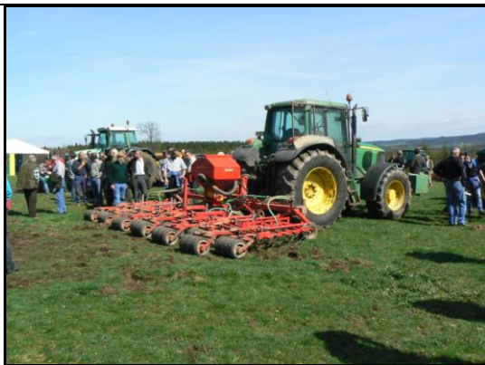
Photo 71. Herse étrille équipée de petits rouleaux et d'un semoir
