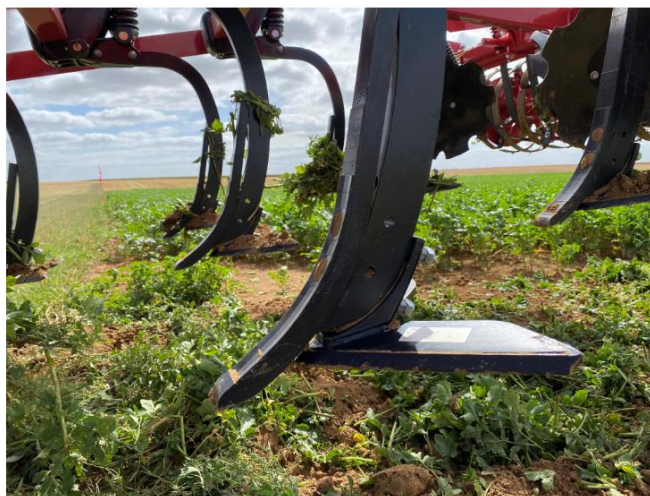
Image 8: Aileron scalpeur sur un déchaumeur à dent Horsch Terrano (Pleinchamps, 2020)
