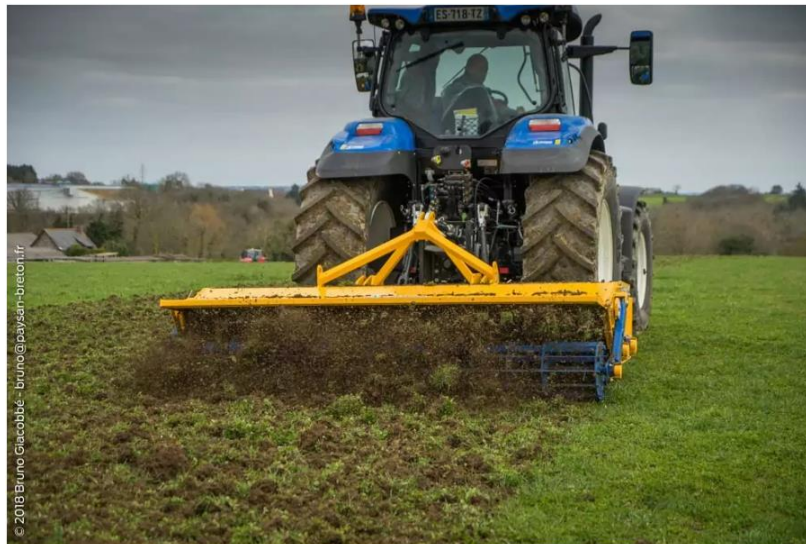
Image 10 : Outil Dyna drive de la marque Bomfort lors de la destruction d'une prairie (Paysan Breton, 2018)
