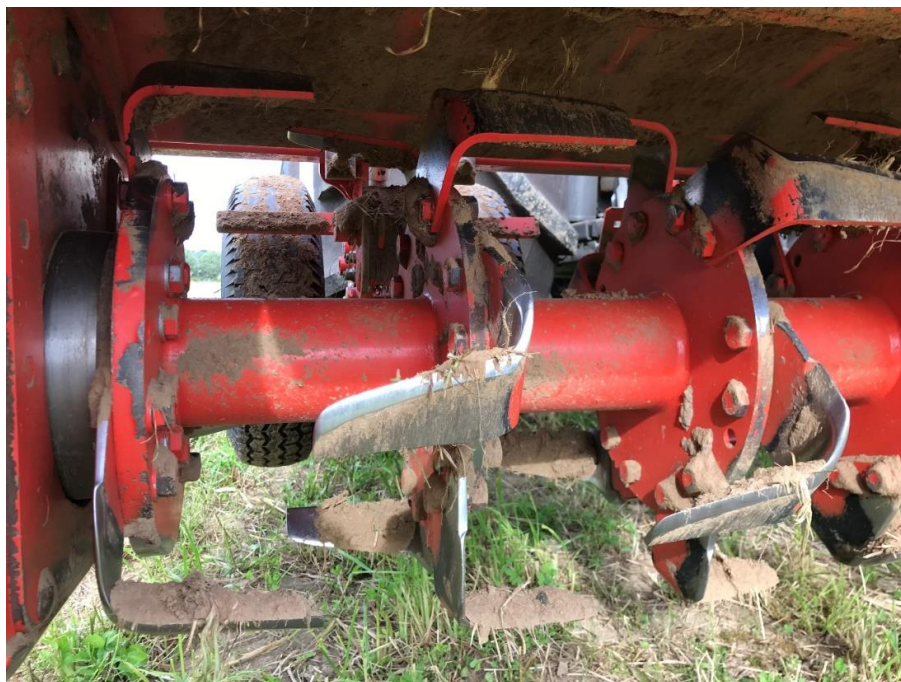
Image 14: Kuhn Biomulch => Dents courbées en angle droit
